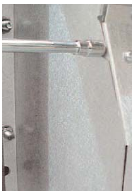
fig.3—Slacken side bolts
